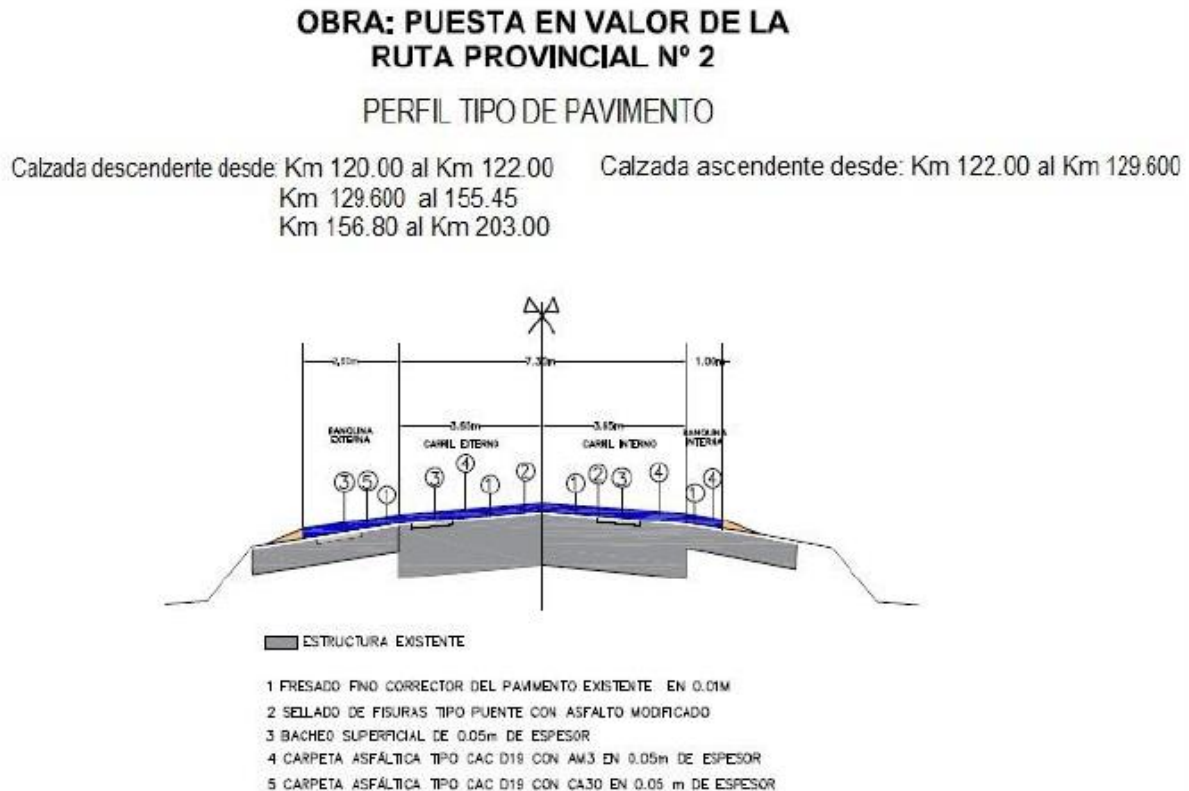
Figura 9. Perfil tipo de pavimento del Tramo 2
