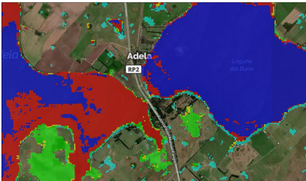
Foto 2. Riesgo hídrico alto en periferia de lagunas Adela y del Burro en progresiva 135+400
